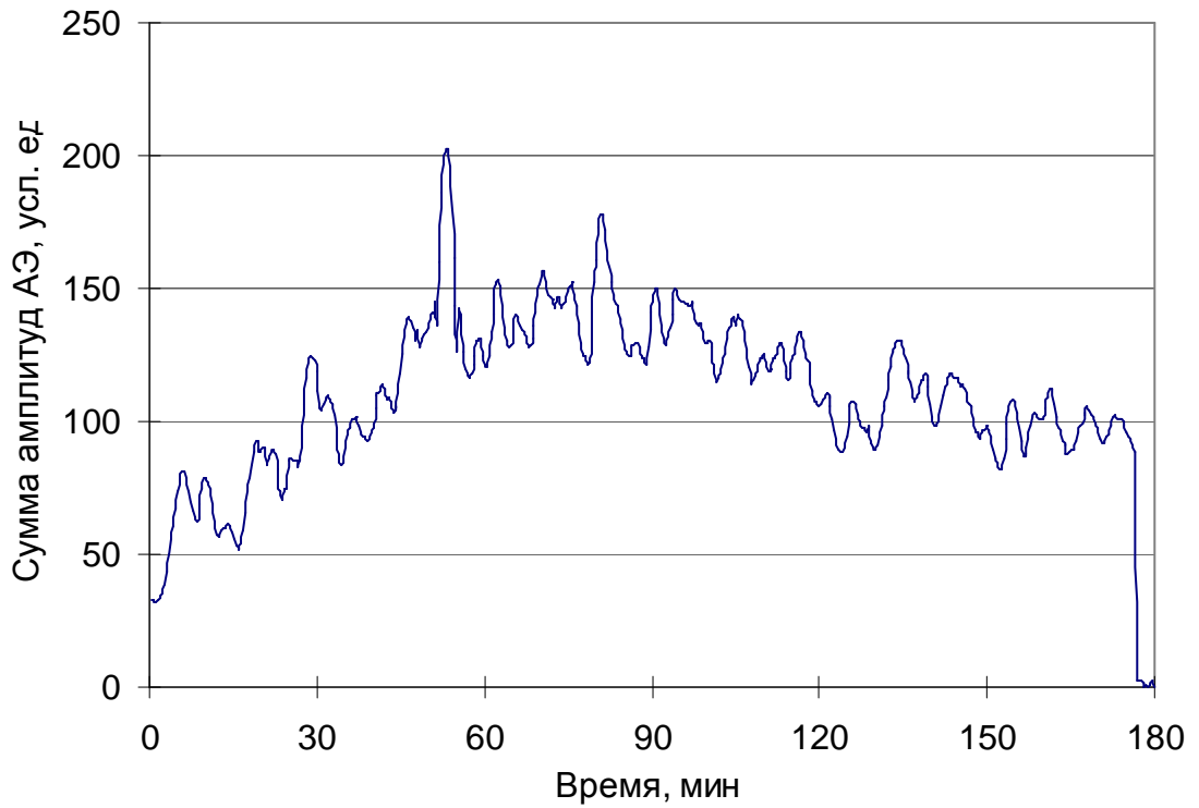
Рис. 5.25. Кинетика изменения суммы амплитуд АЭ, возникающей при структурообразовании РЗЭКМ (состав №3)
