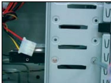
3. 信号ケーブルの向きを合わせ、ハードディスクドライブに接続します。ケーブルの赤く色付けされたサイドがピン1のエンドです。また、中央のノッチと一致させてください。ケーブルをコネクタに無理に接続しないでください。
