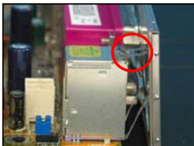
4. マザーボードのI/Oがある面をケースのバックパネル側に向け、マザーボードをケース内部に設置します。
