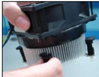
4. 対角線上にある2つのファスナーを同時に押し下げ、ヒートシンクとファンを所定の位置に固定します。
