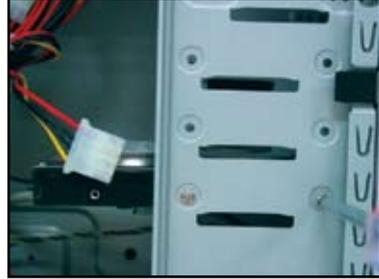
3. SATAケーブルの向きを合わせ、ハードディスクドライブに接続します。ケーブルは一方方向にのみ取り付けすることができます。
