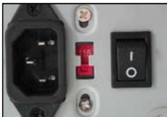
2. パッシブPFC搭載の電源装置を使用している場合、お住まいの地域の正しいAC入力電圧を選択してください。
