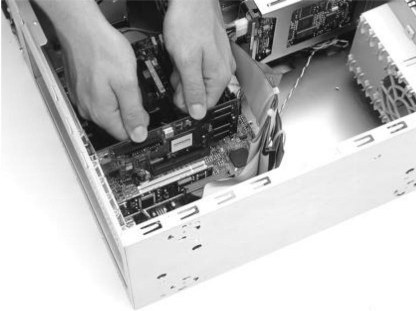
5. Une fois la carte Stealth II G460 mise en place correctement, fixez-la au châssis de l'ordinateur à l'aide de la vis que vous avez déposée au point 2.
