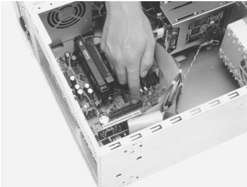
2. Lösen Sie die Schraube an diesem Steckplatz und entfernen Sie die Abdeckblende.
