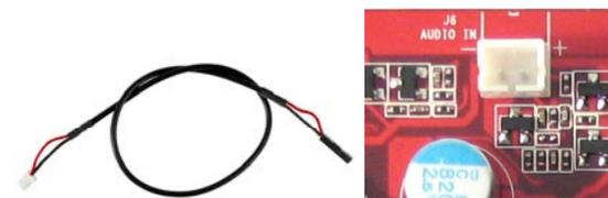
图示 2-2 (SPDIF内部连接线)
